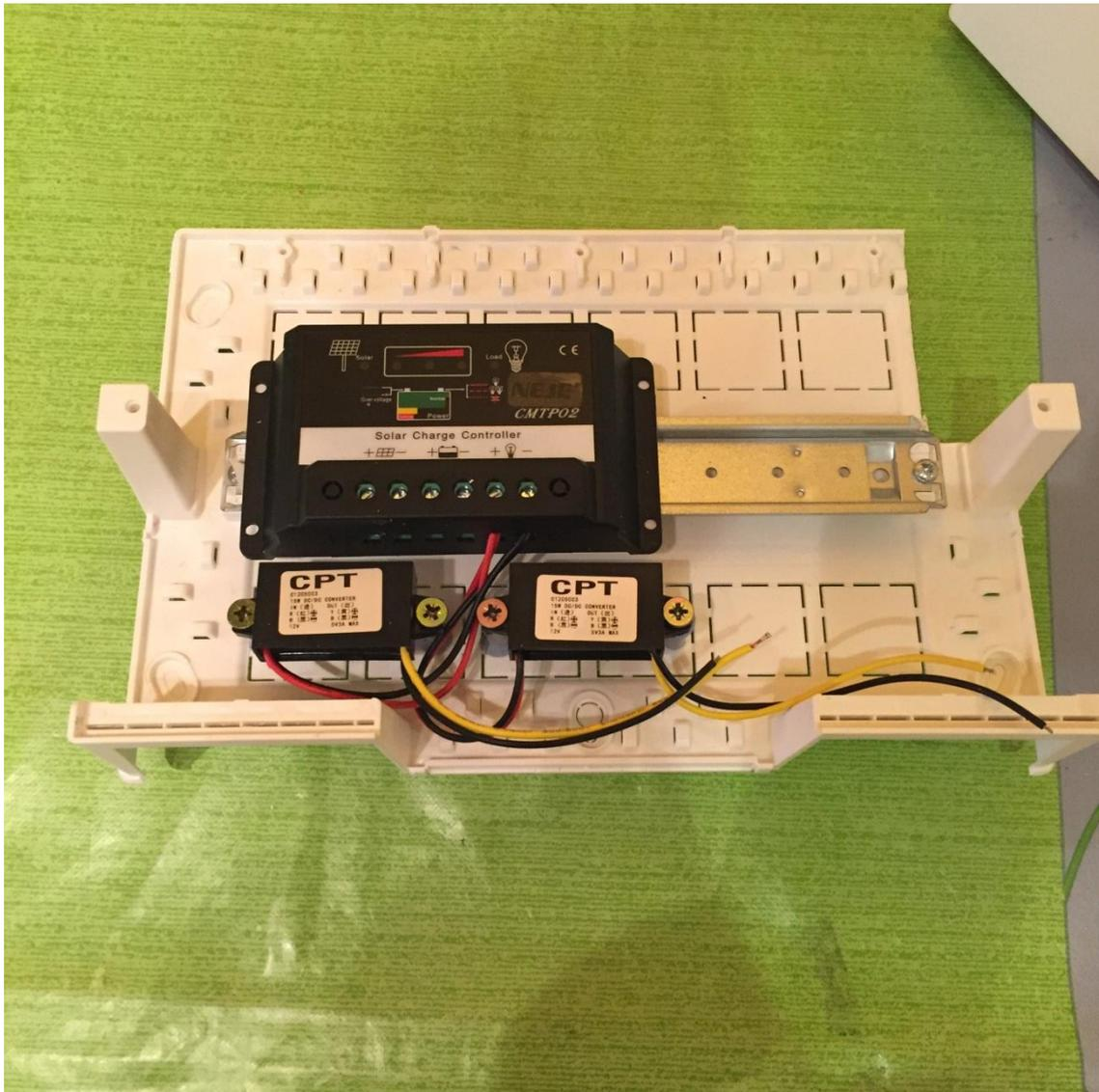
En una segunda etapa de transformación de la tensión hemos optado por 2 transformadores de entrada 12v y salida 5v y un max de 3 amp, que realizan la función de alimentación del cluster y de una seguridad de forma individual a cada nodo. Protegiéndolo de picos de tensión hasta 3 amp que es el max pico de intensidad requerido por cada nodo.
